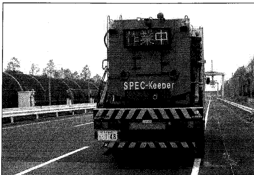
Rys. 30 Samochód do czyszczenia cichych nawierzchni drogowych (źródło: Noise reducing pavements in Japan - study tour report, Danish Road Institute, 2005, DRI-DWW noise abatement program)
